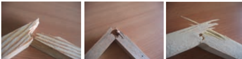
شکل ۴-۲۰ نوع شکست چوب زبان گنجشک در اثر ضربه
