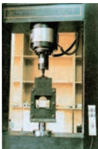
شکل ۴-۳۱- طرز قرار گرفتن نمونه چوب در دستگاه آزمایش
