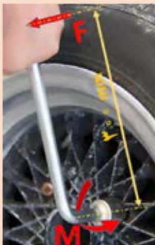
شکل ۱۴-۴ باز کردن پیچ چرخ خودرو توسط آچار چرخ
