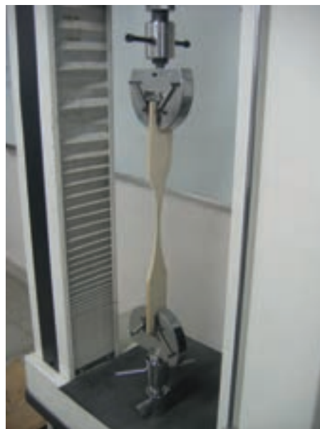
شکل ۴-۲۳ - طرز قرار گرفتن نمونه آزمایش کشش چوب در گیره
