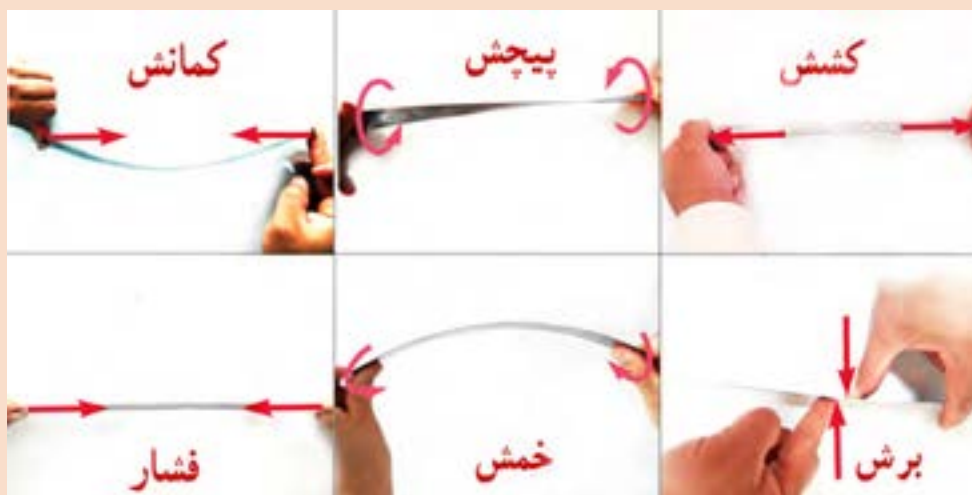
۸ - ۴. انواع بارگذاری بر روی خط کش فلزی
