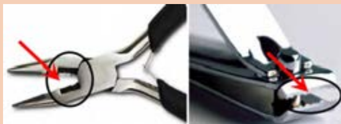
شکل ۴-۲۲ لبه های برنده خراب شده در ناخن گیر و دم باریک
