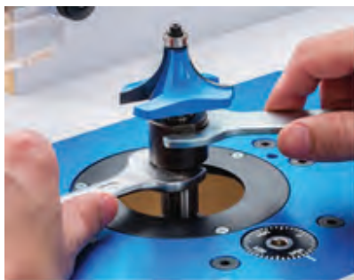
شکل ۲۰۷-۱- قرار دادن تیغه در کولت و محکم کردن آن با آچار
