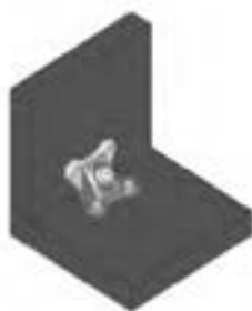
شکل ۷۲-۱ - بست گونیایی متحرک (جدا شدنی)
