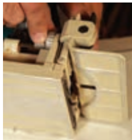
شکل ۱-۱۸۴- تنظیم عمق کنشکاف
