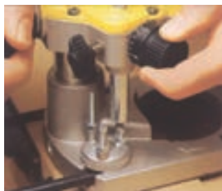
شکل ۲۰۹-۱- پیچ تنظیم دستگاه ۲
