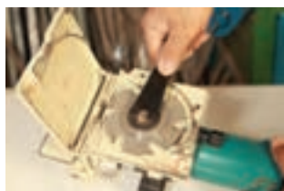
شکل ۱-۱۸۳-ب - روش تعویض تیغه
