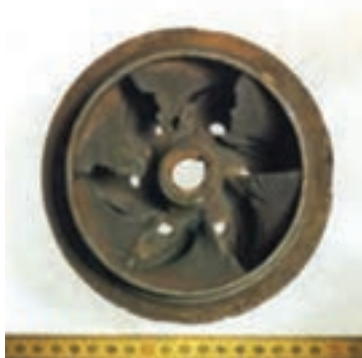
پره پمپ به دلیل قرار گرفتن در محلول خورنده حاوی ذرات ماسه دچار خوردگی فرسایشی شده است.
