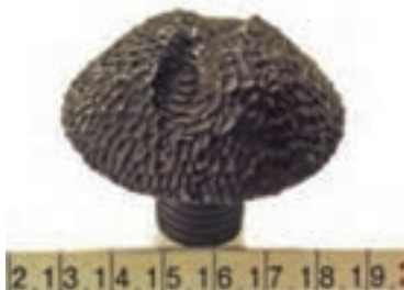
پیچ در محلول خورنده حاوی ذرات ساینده دچار خوردگی فرسایشی شده است.
