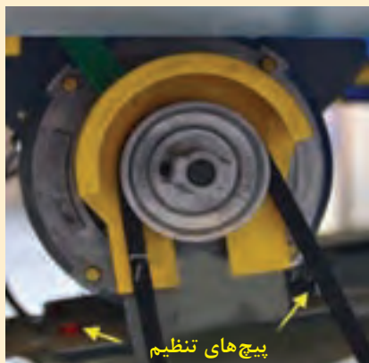
پیچ‌های تنظیم موتور
