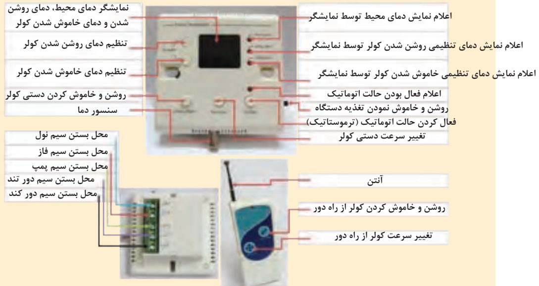
مدار کلید هوشمند کولر آبی
