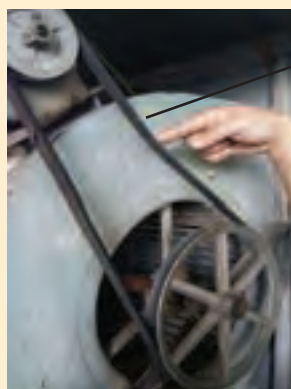
آزمایش سفتی تسمه
