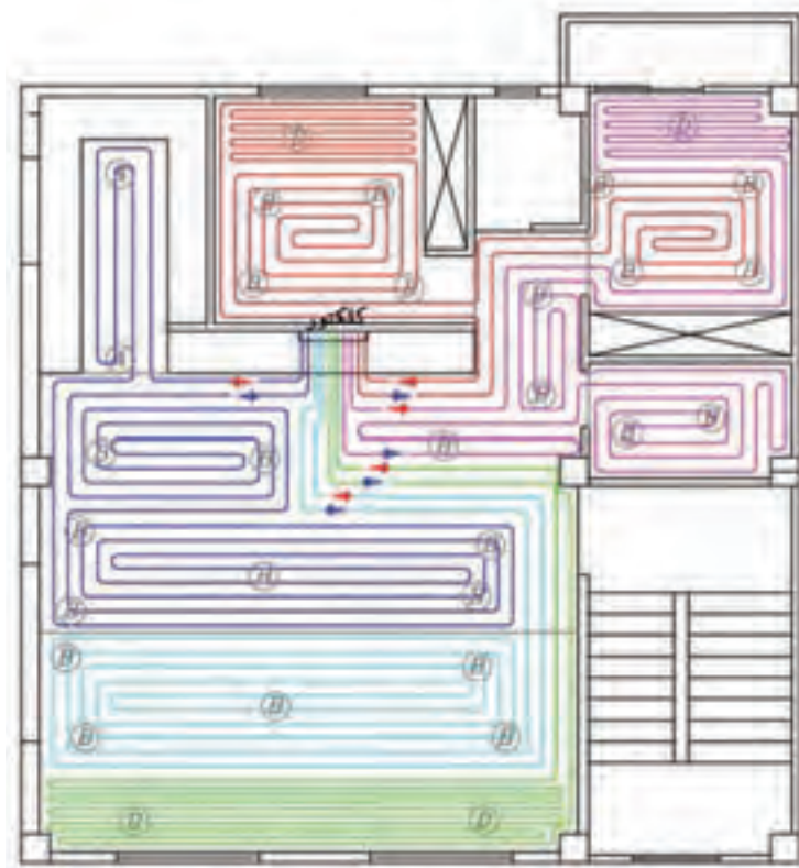
کلکتور سیستم کف گرمایی
