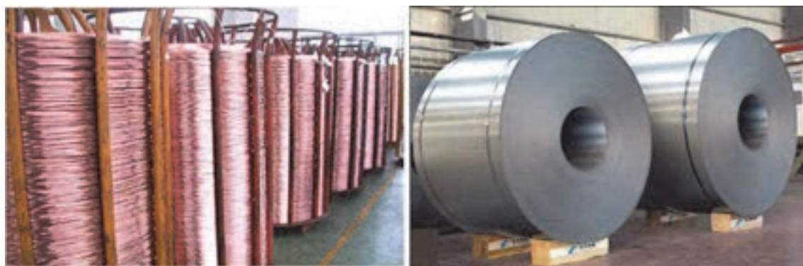
شکل ۱۱-۵: نحوه انبار کردن رول‌ها
