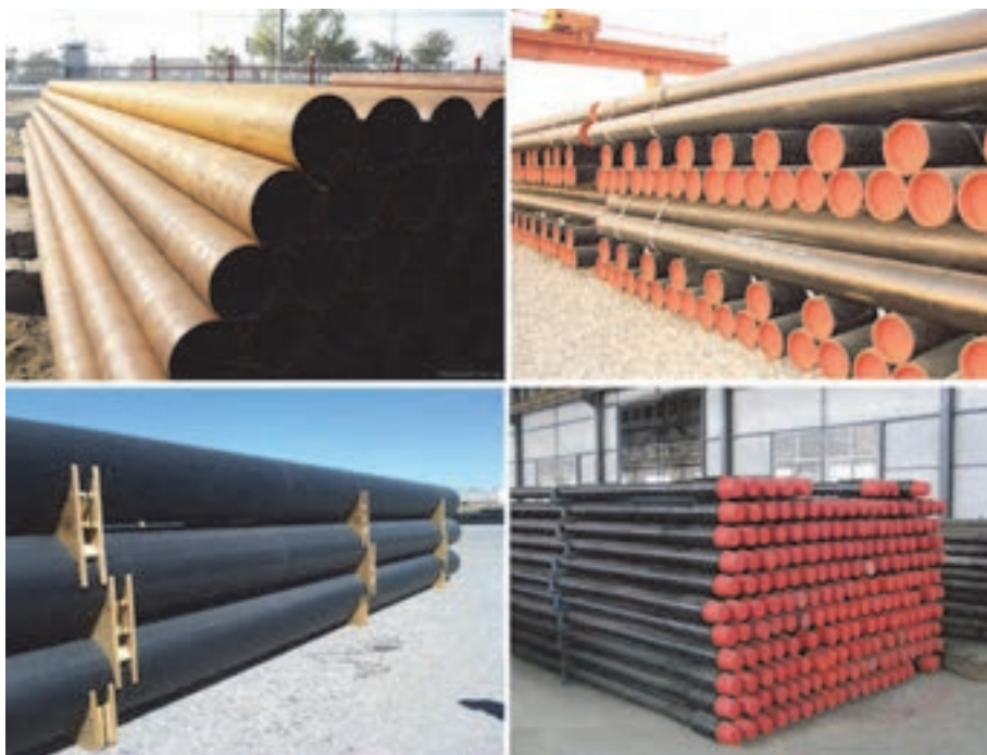
شکل ۱۰-۵: روش‌های مختلف انبار کردن لوله در انبار
