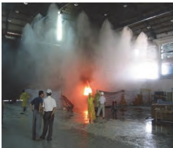
شکل ۱۱-۴: سیستم پاشش آب اطفاء حریق
