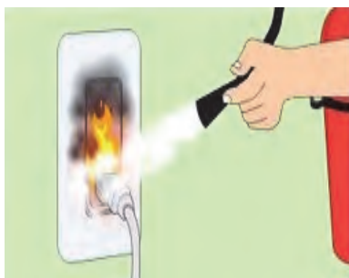
شکل ۱۳-۳ عدم استفاده از کپسول آب در آتش سوزی های برقی
