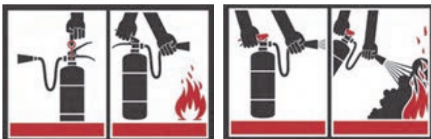
شکل ۱۶-۳ نحوه استفاده از خاموش کننده ها
