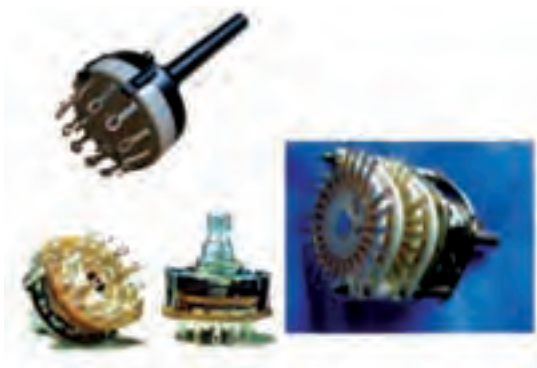
شکل ۶-۶ انواع کلیدهای چرخشی چند حالتی
