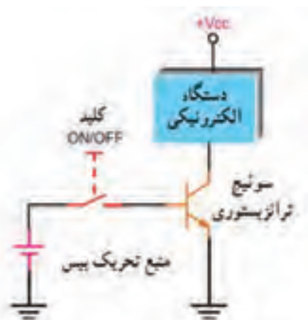
کلید یک حالتی الکترونیکی با استفاده از یک ترانزیستور
