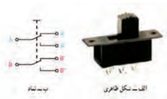
شکل ۱-۶ تصویر کلید تبدیل دوبل و نماد فنی آن
