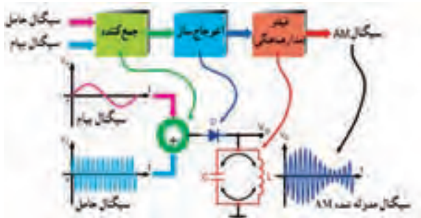
شکل ۱-۵-۱ بلوک دیاگرام مدولاتور دیودی AM
