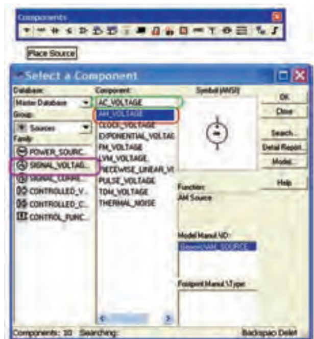
شکل ۵-۱۴ مسیر دسترسی به سیگنال ژنراتورهای صوتی و مدار سیگنال AM
