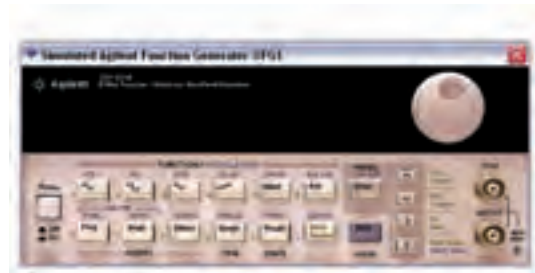
شکل ۲-۲ نمای ظاهری دستگاه فانکشن ژنراتور
