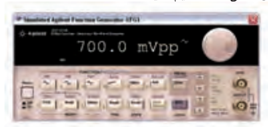
شکل ۳-۲ تنظیم دامنه در حالت AM
