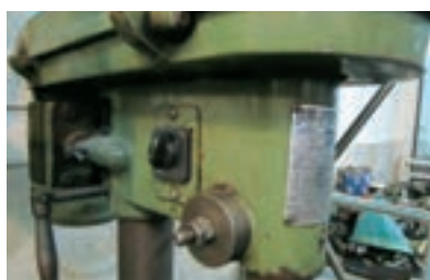
شکل ۵-۲۰ شکل ظاهری و نمونه کاربردی کلید زبانه‌ای چپ گرد، راست گرد.
