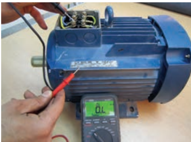
شکل ۵-۸ تست اتصال بدنه.
