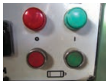
شکل ۵-۶۵ کاربرد لامپ‌های سیگنال در یک نمونه دستگاه تراش
