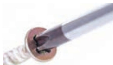
(الف) استفاده صحیح از آچار پیچ گوشتی
