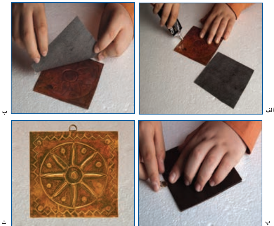
شکل ۱۰-۱۲ تبدیل پلاک مسی به دیوارکوب
