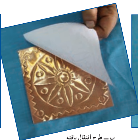
شکل ۴-۱۰ نحوه انتقال طرح روی ورق مسی
