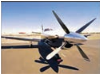
شکل ۸-۴ ملخ پیچی است که هوا یا آب را می‌برد و به جلو می‌رود.
