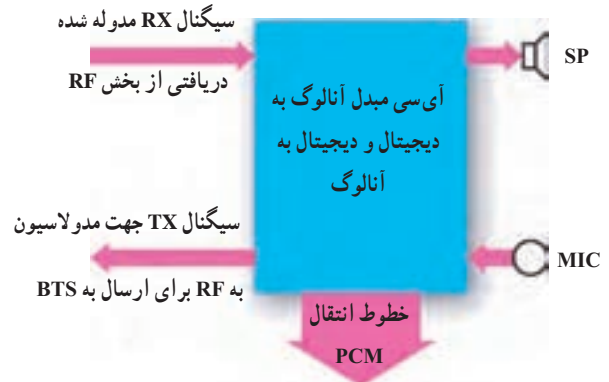
شکل ۲۵-۱۹- ورودی ها و خروجی های IC در بخش AF
