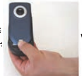
۳ با فشار کمی روی زائده یا دکمه قاب پشت، قاب را آزاد کنید.
