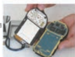
شکل ۴۹-۱۹- مراحل باز کردن اجزای یک نوع گوشی تلفن همراه
