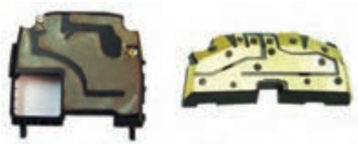
شکل ۱۹-۳۷- آنتن و اجزای آن
