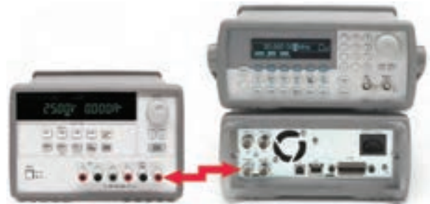
شکل ۱۷-۳- اتصال منبع تغذیه DC به ورودی VCO
