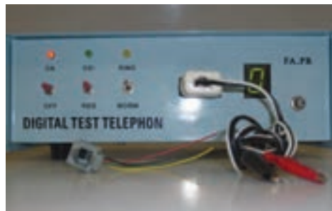
شکل ۱۶-۱۹- نمونه ای از تستر تلفن
