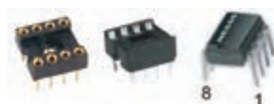
شکل ۹-۳۵- شکل ظاهری و سوکت آی‌سی NE ۵۵۵
