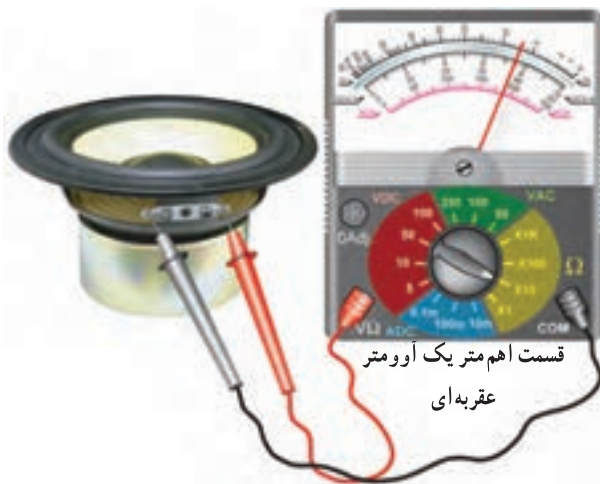
شکل ۵-۱۳- اندازه گیری مقاومت اهمی بلندگو با اهم متر
