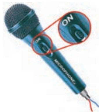
شکل ۵-۹ حالت کلید میکروفون دینامیکی در اندازه‌گیری مقاومت اهمی آن
