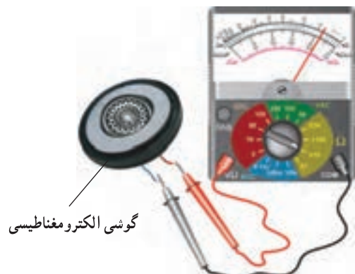
شکل ۵-۱۲- نحوه اتصال گوشی الکترومغناطیسی به اهم متر
