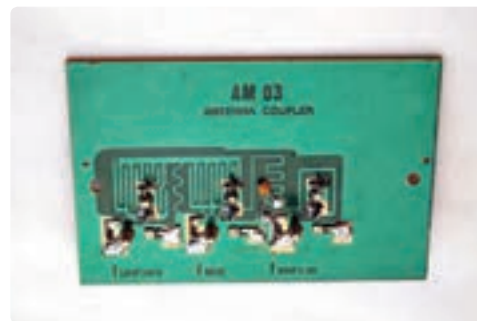
شکل ۴-۵- ترکیب کننده دو سیگنال و بُرد آن
