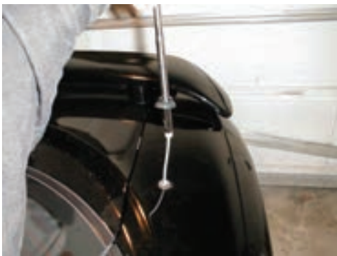
شکل ۵۸-۲- محل نصب آنتن اتومبیل
