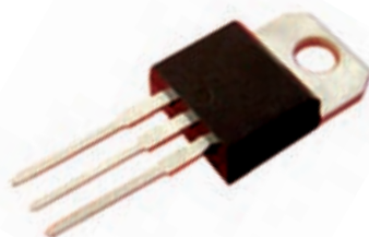
شکل ۴-۴۱- زوج دارلینگتون در یک بسته بندی
