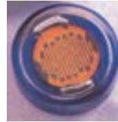
شکل ۱-۱۴- نمای ظاهری و علامت اختصاری یک فتورزیستور
