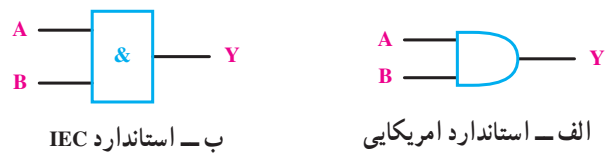
شکل ۱۱-۲ - علائم اختصاری دروازه‌ی AND
