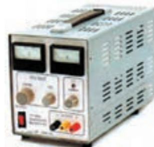
منبع تغذیه‌ی الکترونیکی با وسایل اندازه‌گیری آنالوگ
