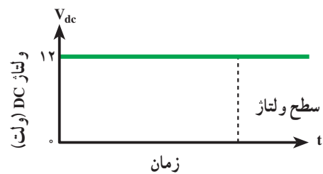
الف- ولتاژ dc ثابت ۱۲ ولت
