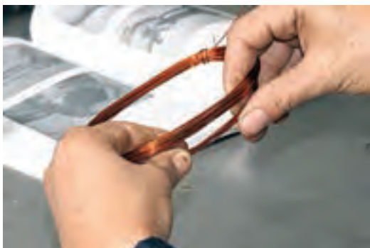
شکل ۱۶-۶- مرتب کردن سیم‌ها جهت کلاف گذاری
