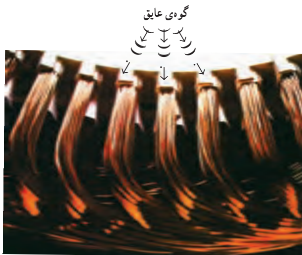
شکل ۲۰-۶ محکم کردن سیم‌ها در داخل شیار با گوده‌ی عایق
