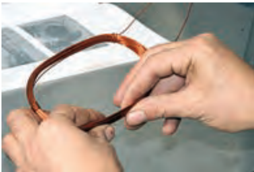
شکل ۱۵-۶- طریقه در دست گرفتن کلاف
