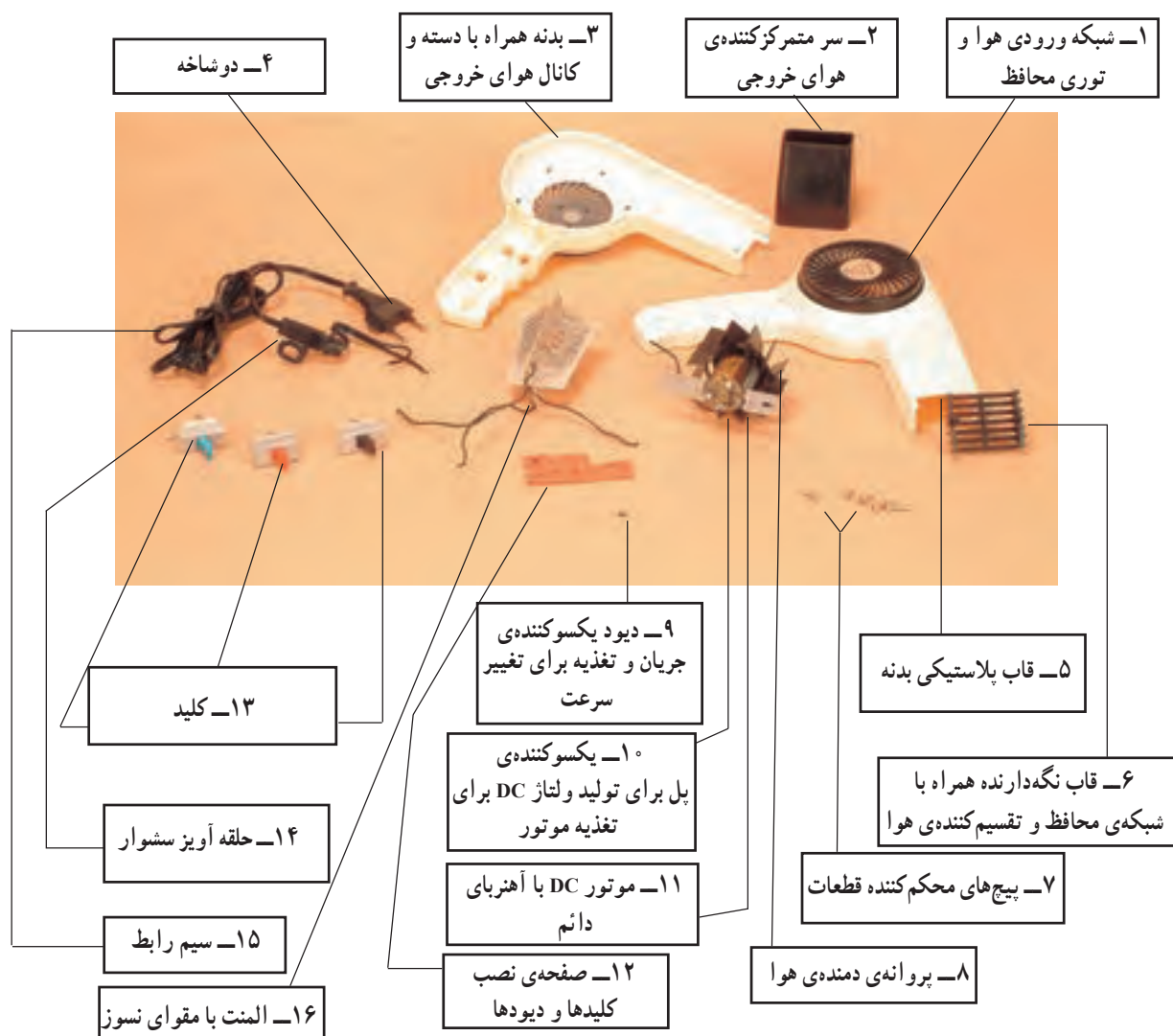
شکل ۴۲-۶- اجزای ساختمانی یک نمونه سشوار
