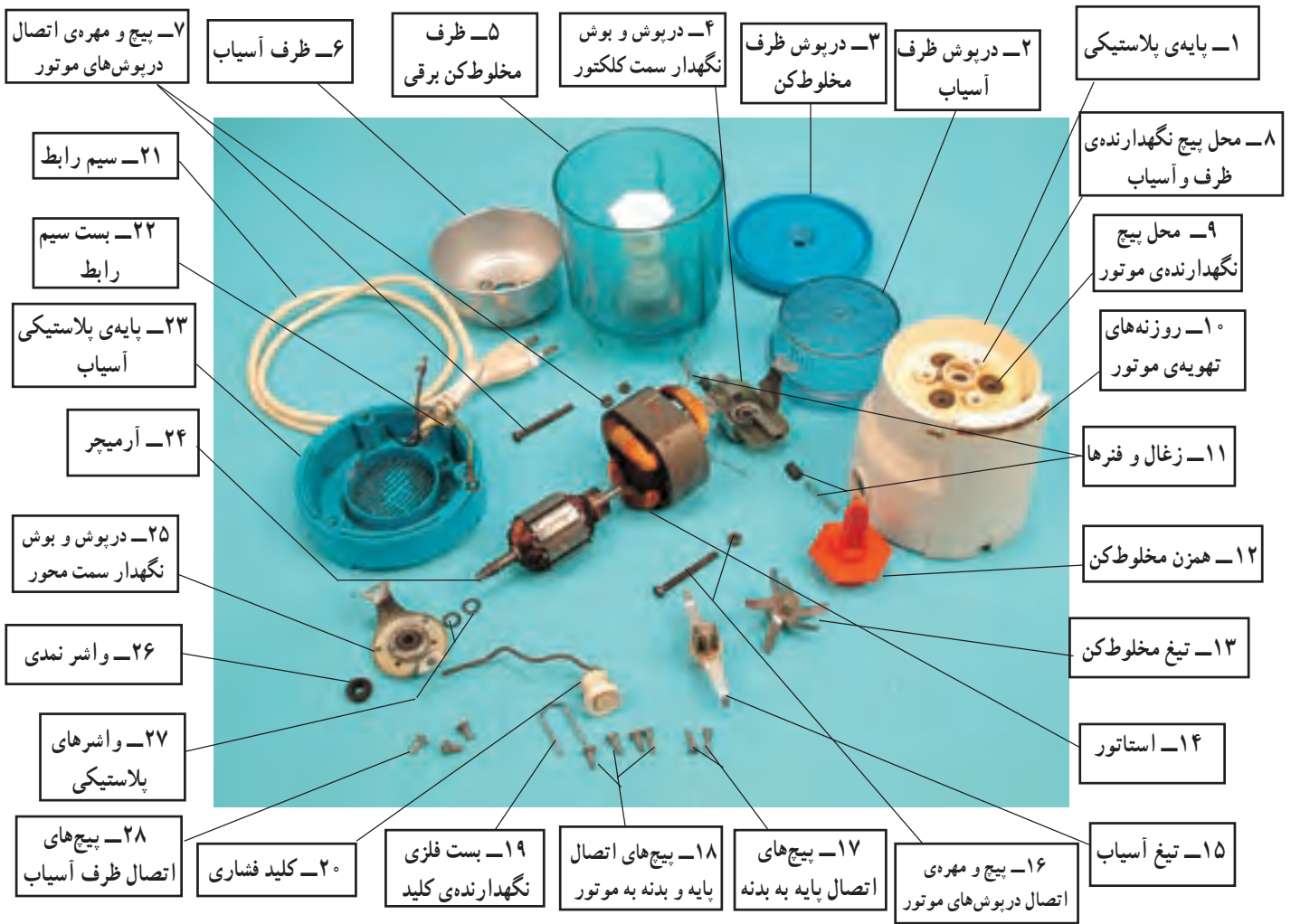
شکل ۴-۳۲- اجزای ساختمانی یک نمونه مخلوط‌کن برقی
