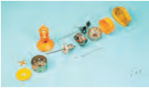
شکل ۱۸-۸ - نمایش ظاهری و اجزای یک واترپمپ
