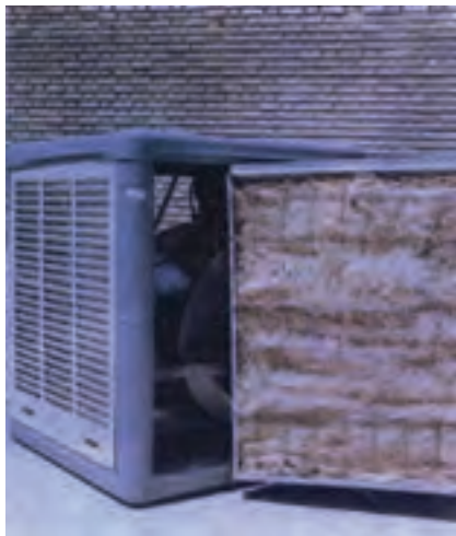
ب - ساختمان اطاقک یک کولر
