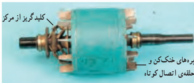
شکل ۸-۶ - روتور یک موتور کولر با پره‌های خنک کن و کلید گریز از مرکز
