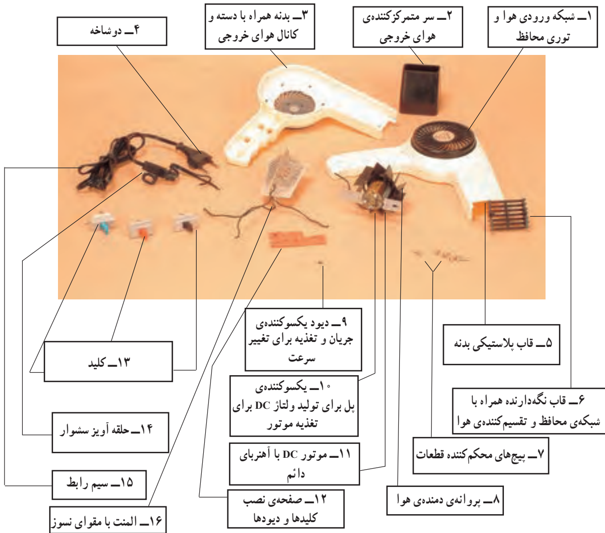
شکل ۴۲-۶ اجزای ساختمانی یک نمونه سشوار
