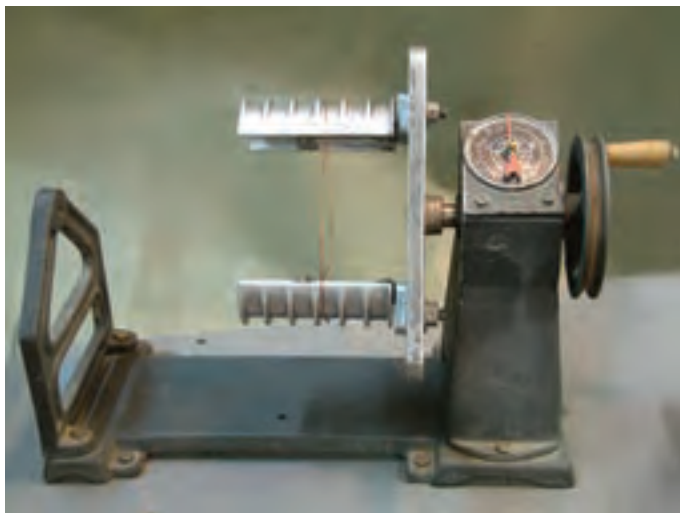
شکل ۹-۶- طریقه‌ی اندازه‌کردن بوبین در کلاف پیچ
