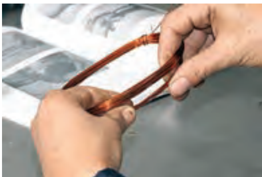
شکل ۱۶-۶- مرتب کردن سیم‌ها جهت کلاف گذاری
