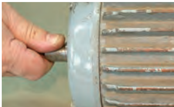
شکل ۳۰-۶ - آزمایش لنگی (لقی) بوش‌ها یا بلبرینگ‌ها
