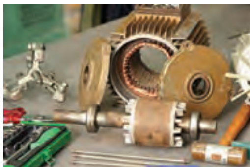
ت- جدا کردن قطعات موتور
