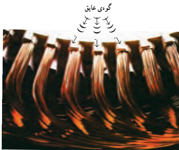
شکل ۲۰-۶ محکم کردن سیم‌ها در داخل شیار با گوهی عایق
