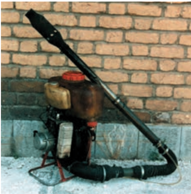
شعله افکن جهت حرارت دادن
