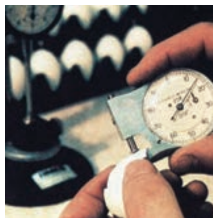
تصویر ۲۵-۱ اندازه‌گیری ضخامت یوسته با میکرومتر
