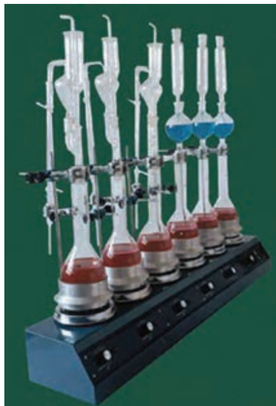
شکل ۴-۱- دستگاه اندازه‌گیری پروتئین (کلدال)
