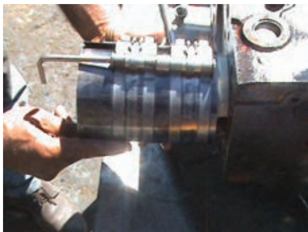
شکل ۱۹۸-۴- جمع کردن رینگ‌ها با رینگ جمع کن
