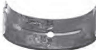
شکل ۴-۱۶۷ نقاط ذوب‌شده روی یاتاقان
