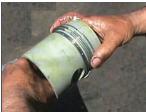
شکل ۱۹۶-۴- تنظیم کردن دهانه رینگ‌ها
