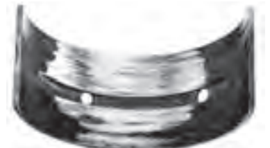
شکل ۴-۱۶۶ سایش یاتاقان به دلیل لقی کم بین میل‌لنگ و یاتاقان
