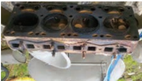
شکل ۴-۲۰۹- رسوبات کربن سطح سرسیلندر
