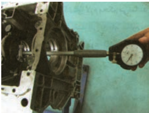
شکل ۱۷۲-۴ اندازه‌گیری قطر داخلی یاتاقان با ساعت اندازه‌گیری
