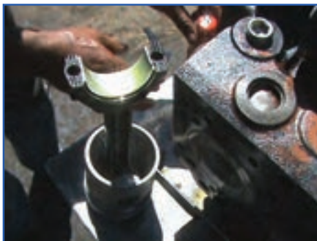
شکل ۱۹۲-۴ روغن‌کاری رینگ‌ها، پیستون و یاتاقان
