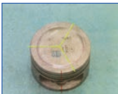
شکل ۱۳۵-۴ زاویه قرار گرفتن رینگ‌ها نسبت به هم
