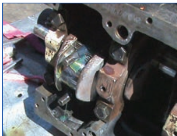
شکل ۲۰۳-۴ جا زدن شاتون روی میل لنگ
