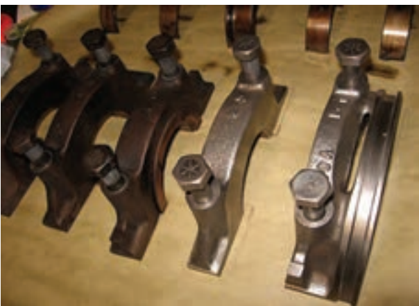
شکل ۱۵۴-۴ چیدن کپه یاتاقان‌ها
