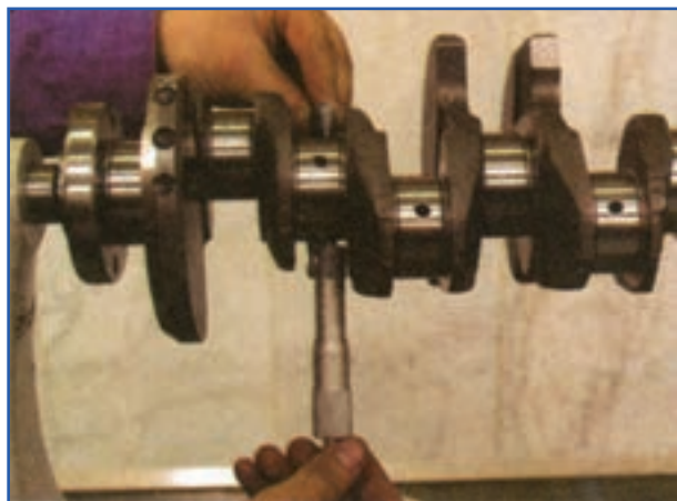
شکل ۱۶۲-۴ اندازه گیری قطر محورهای میل لنگ
