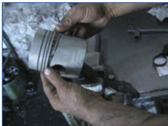
شکل ۱۳۸-۴ جازدن رینگ با دست
