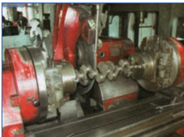
شکل ۱۶۴-۴ دستگاه میل لنگ تراشی
