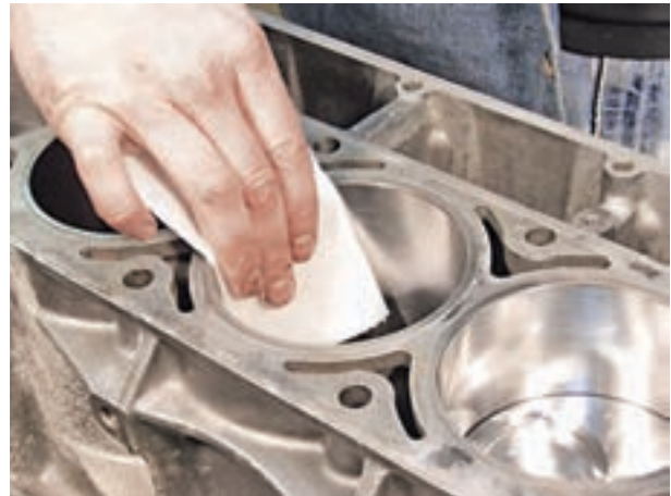
شکل ۴-۲۰۸- تمیز کردن داخل سیلندر
