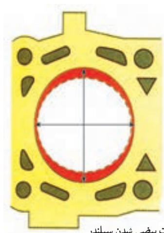
شکل ۱۴۹-۴ وضعیت بیضی شدن سیلندر
