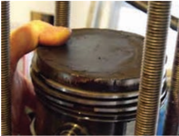
شکل ۴-۲۰۷- رسوبات کربن روی سطح پیستون
