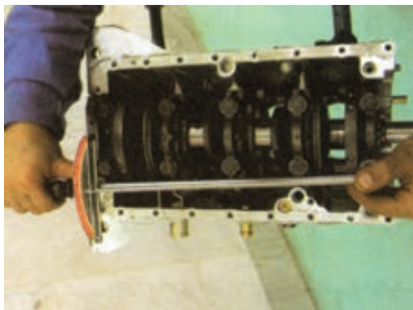
شکل ۱۹۱-۴ - کشیدن پیچ‌های یاتاقان‌های ثابت با گشتاور مناسب
