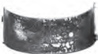
شکل ۴-۱۶۸ اثرات سوختگی روی یاتاقان
