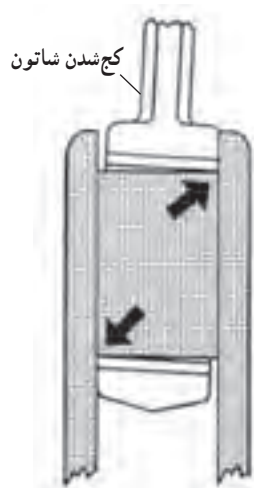
شکل ۴-۱۶۹ وضعیت ساییدگی یاتاقان به دلیل کج قرار گرفتن شاتون روی محور میل‌لنگ
