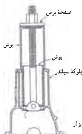
شکل ۱۴۳-۴- نحوه پیاده کردن بوش سیلندر
