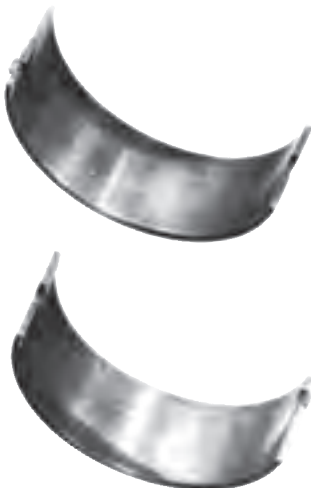
شکل ۴-۱۶۹ وضعیت ساییدگی یاتاقان به دلیل کج قرار گرفتن شاتون روی محور میل‌لنگ
