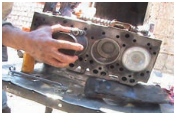
شکل ۱۹۹-۴- چسباندن رینگ جمع کن به سیلندر
