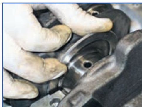
شکل ۱۸۴-۴ جازدن بغل یاتاقانی
