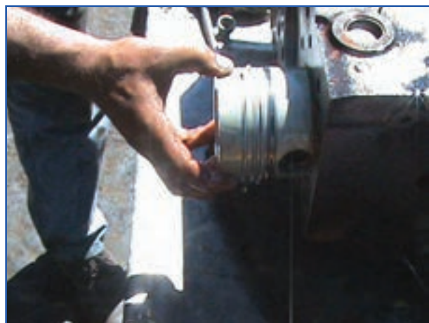
شکل ۱۹۷-۴- قرار دادن پیستون در سیلندر
