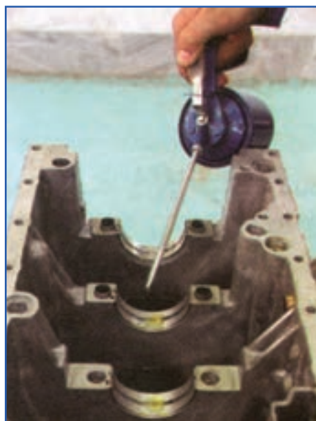
شکل ۱۸۷-۴ روغن کاری یاتاقان‌های ثابت
