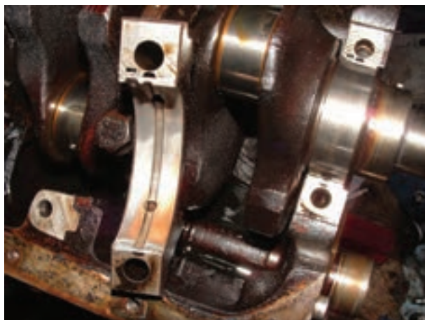
شکل ۱۸۲-۴ باز کردن کپه یاتاقان ثابت
