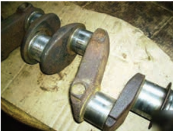
شکل ۴-۲۱۰- میل لنگ با رسوبات کربن
