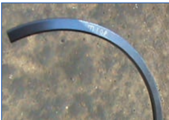
شکل ۱۳۴-۴ علامت TOP روی رینگ
