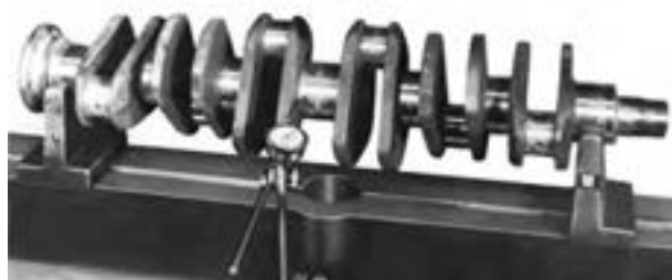
شکل ۴-۱۶۰- دستگاه اندازه‌گیری تاب میل‌لنگ
