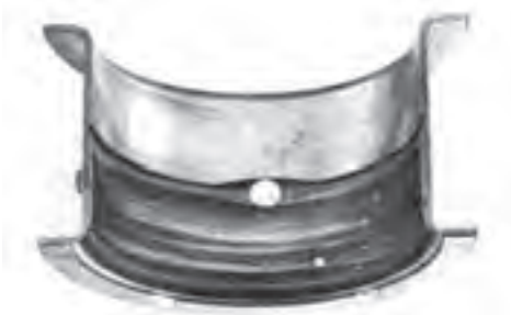
شکل ۴-۱۶۵ خط به دلیل نفوذ ذرات ریز و درشت بین میل‌لنگ و یاتاقان
