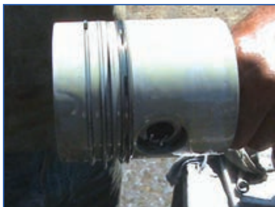
شکل ۱۴۰-۴ روغن‌کاری همه رینگ‌ها و پیستون
