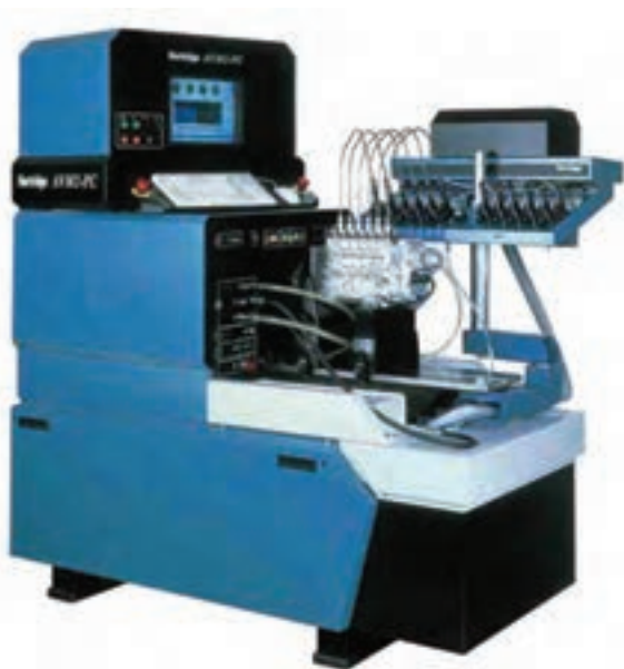
شکل ۲۴- دستگاه آزمودن و تنظیم پمپ انژکتور
