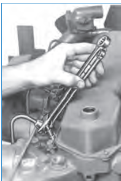
شکل ۲۲-۴ باز کردن لوله‌های فشارقوی انژکتورها
