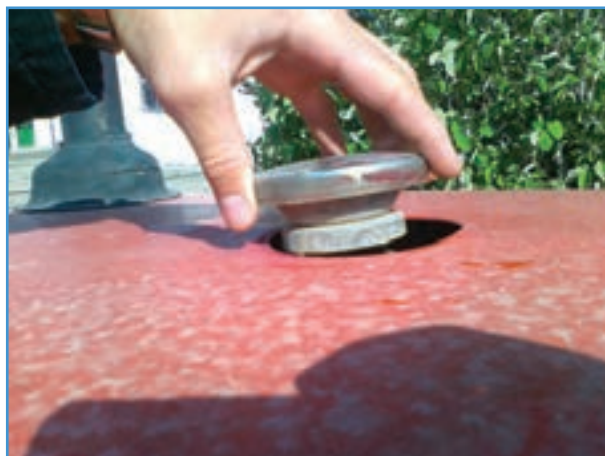
شکل ۷-۳ باز کردن در رادیاتور تراکتور MF285
