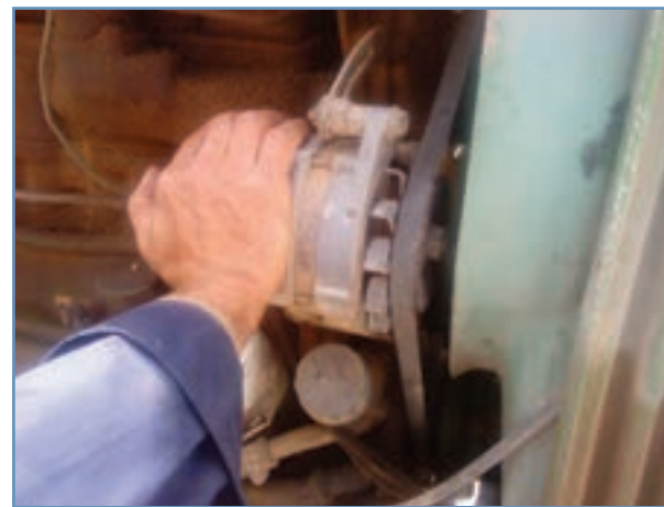
شکل ۳۰-۳ فشار دادن مولد به سمت موتور
