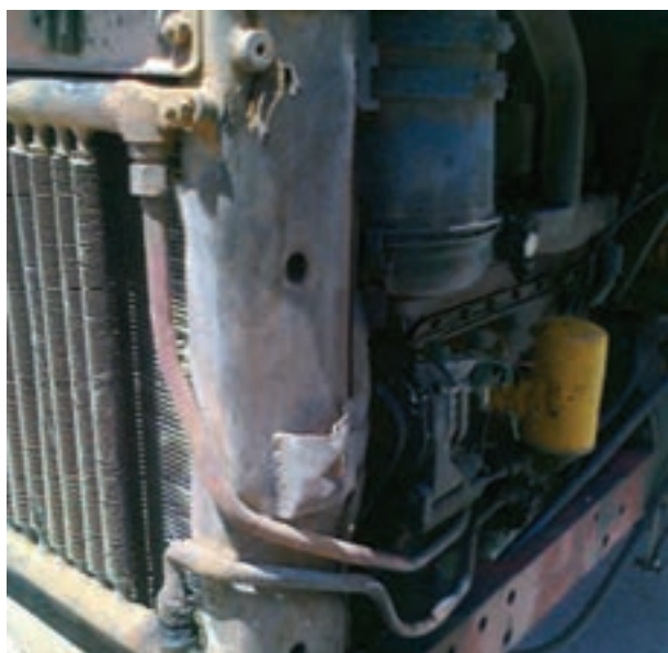
شکل ۱۲-۳ - محل مهره‌های رادیاتور روغن
