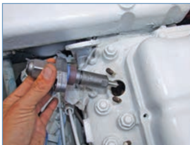
شکل ۲۳-۴ خارج کردن انژکتور
