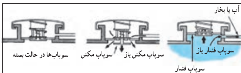
الف) وضعیت سوپاپ‌های در رادیاتور
