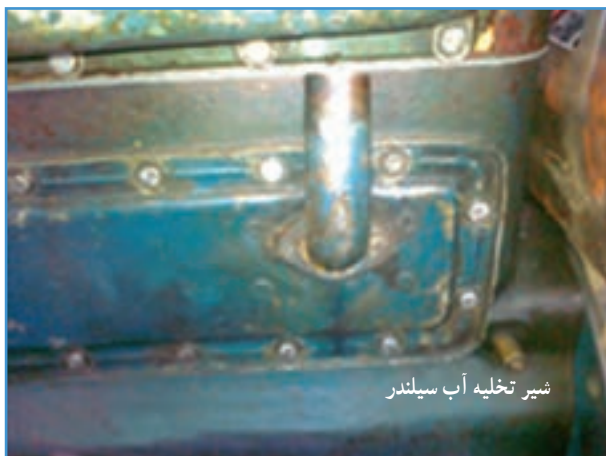
شکل ۸-۳ شیر تخلیه آب سیلندر تراکتور U650
