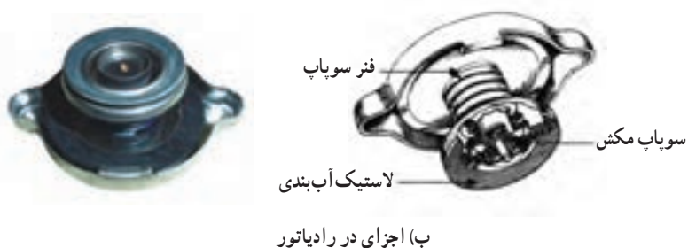
شکل ۳-۵- در رادیاتور و طرز کار سوپاپ‌های آن
