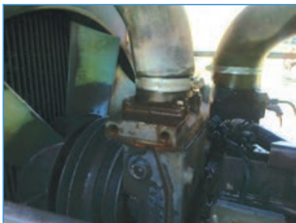
شکل ۱۱-۳ - محل بست شیلنگ محفظه ترموستات
