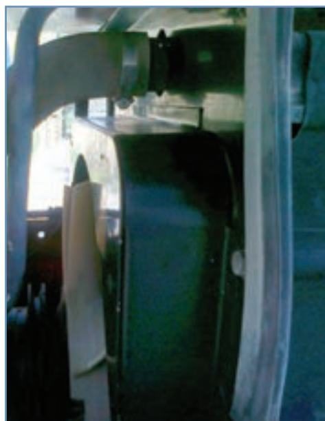
شکل ۳۲-۳. محل بادگیر رادیاتور در تراکتور MF399
