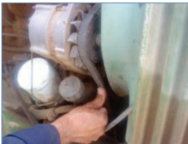
شکل ۲۸-۳ اندازه‌گیری کشش تسمه با فشار انگشت
