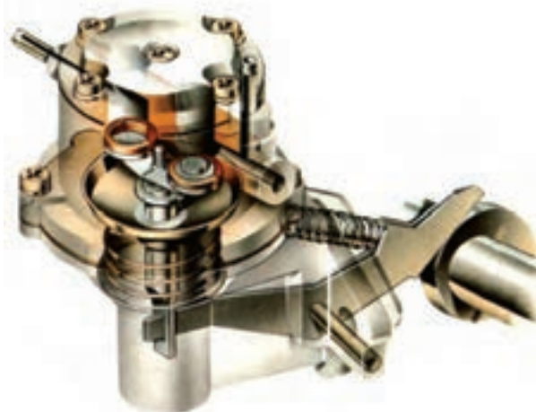
شکل ۷-۴ پمپ مقدماتی دیافرآگمی
