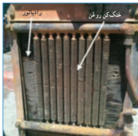
الف) خنک‌کن روغن تراکتور U650
