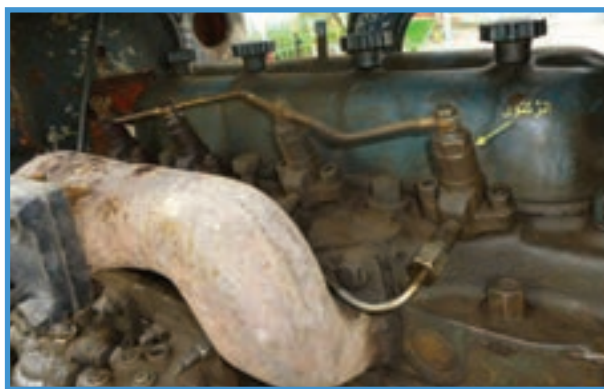
شکل ۳۲-۲- انژکتورهای تراکتور U650M
