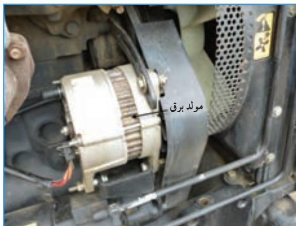
شکل ۴۷-۲ — مولد برق تراکتور MF285
