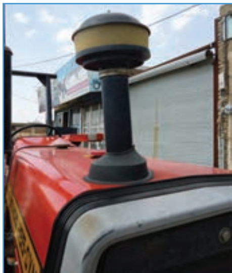
شکل ۲۵-۲ پیش صافی تراکتور MF285
