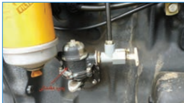
شکل ۲۹-۲ پمپ مقدماتی تراکتور MF285
