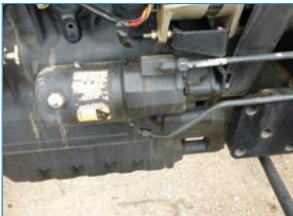
شکل ۲۳-۲. پمپ هیدرولیک فرمان و صافی تراکتور MF285
