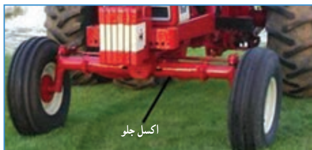
شکل ۲۲-۲- اکسل جلو تراکتور
