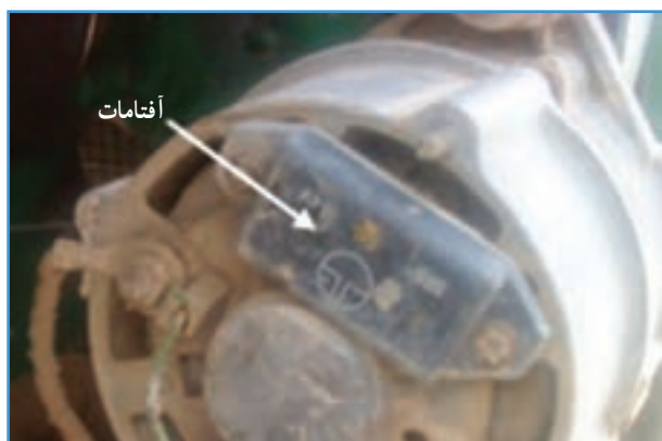
الف) آفتامات روی آلترناتور تراکتور JD3140
