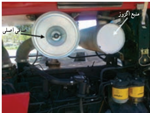
شکل ۲۶-۲ صافی اصلی تراکتور MF399
