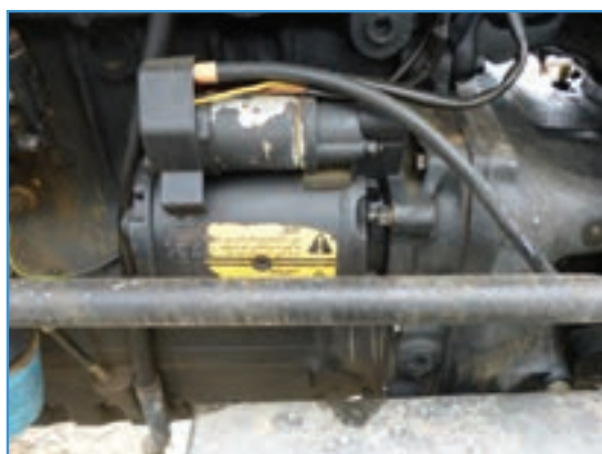
شکل ۴۵-۲- استارت تراکتور MF285
