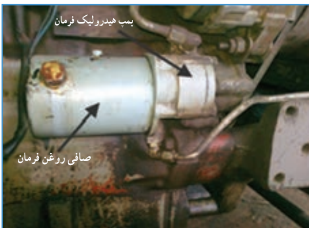
شکل ۲۳-۲. پمپ هیدرولیک فرمان و صافی تراکتور MF285
