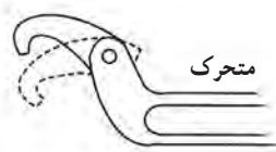
شکل ۵۹-۳ نحوه استفاده از آچار مهره‌ای گرد
