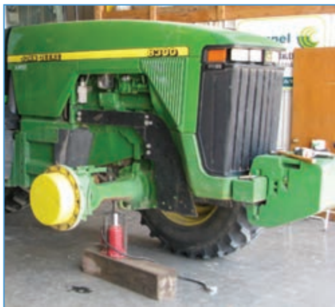
شکل ۱۱-۴- قرار دادن جک روغنی زیر جسم سنگین
