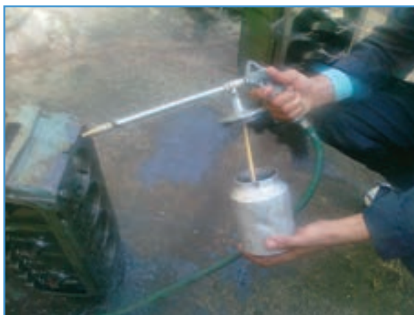
شکل ۱-۳- باز کردن مخزن پیستوله شستشو
