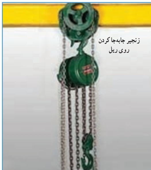
شکل ۲۰-۴ - اتصال جرثقیل سقفی به ریل
