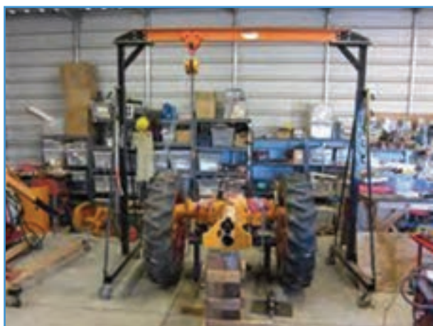
شکل ۲۴-۴ کاربرد جرثقیل دروازه‌ای متحرک
