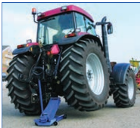
شکل ۱۳-۴ کاربرد جک سوسماری
