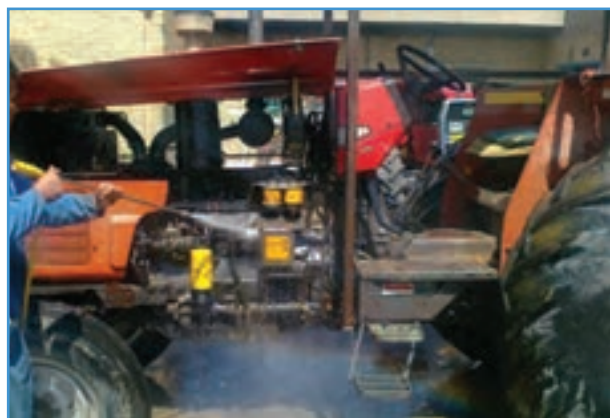
شکل ۵-۱- شستشوی موتور تراکتور
