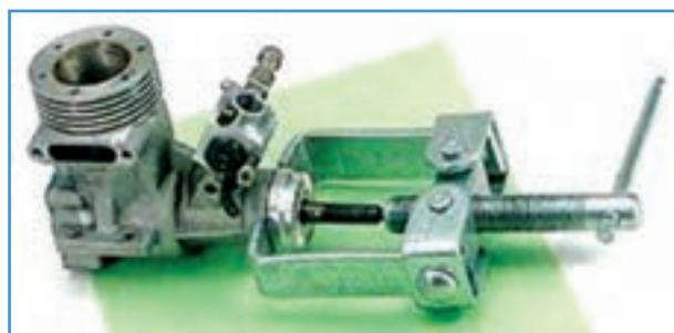
شکل ۷۷-۳- خارج کردن بلبرینگ با بلبرینگ کش
