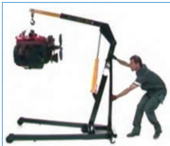
شکل ۱۸-۴ کاربرد از جرثقیل متحرک دستی
