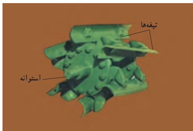
شکل ۳-۲- استوانه خردکننده به همراه تیغه‌ها
