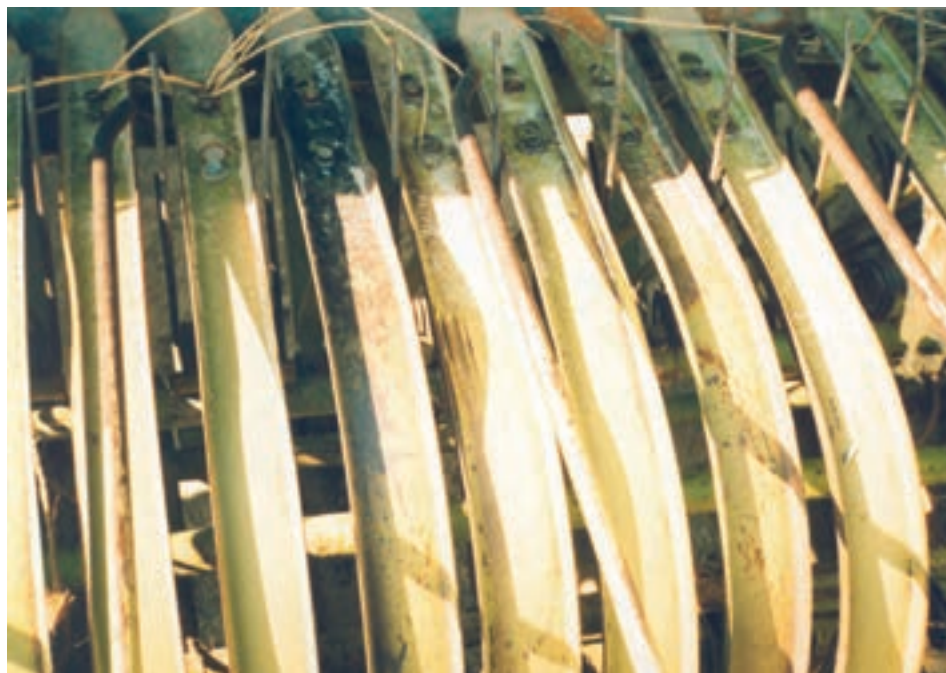
شکل ۱۹-۱- ساییده شدن انگشتی‌ها به طوقه‌ها
