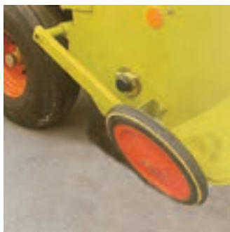
شکل ۳۹-۱- چرخ تنظیم کج شده
