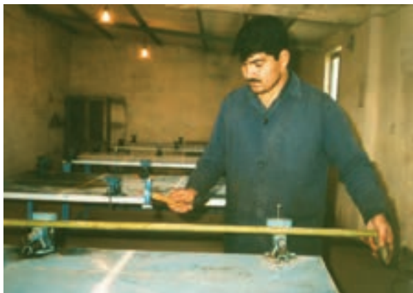
شکل ۱-۲۴ فردی در حین صاف کردن محور انگشتی‌ها
