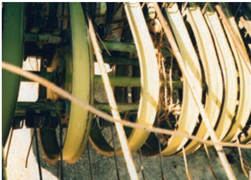
شکل ۲۹-۱- محور انگشتی کج شده
