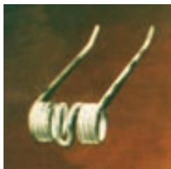
شکل ۱۸-۱- انگشتی کج شده، شکسته و ساییده شده
