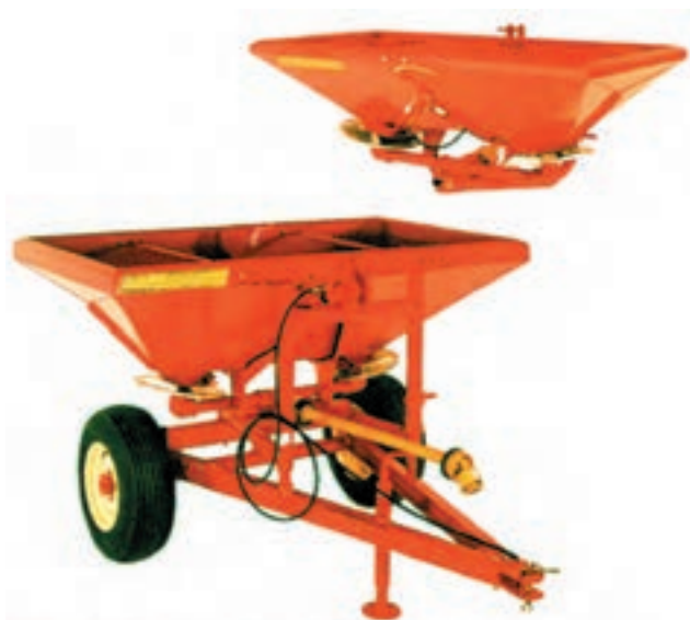
شکل ۲-۲- بذریاش سانتریفوژ با چرخهای ثابت (کششی)
