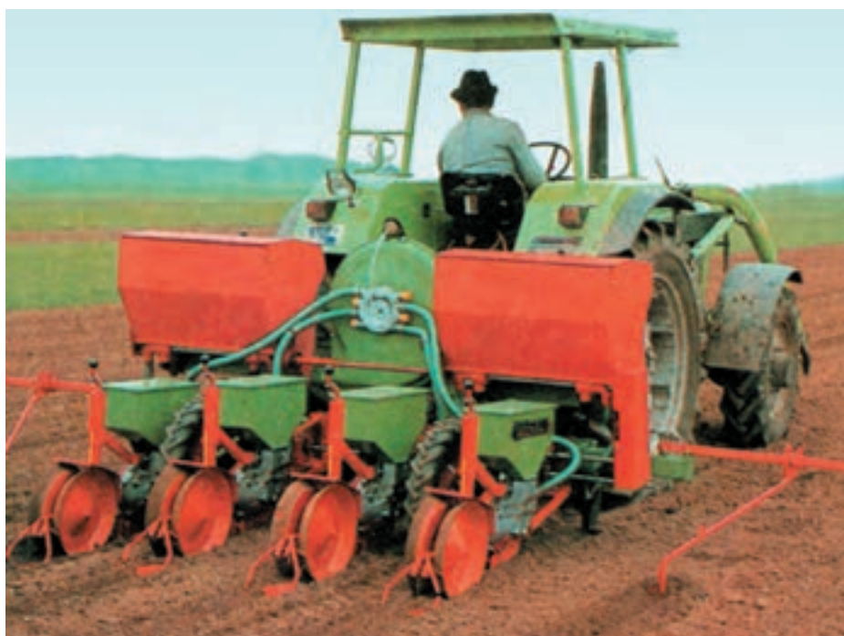
شکل ۲-۴- یک ردیفکار پنوماتیکی حین انجام کار
