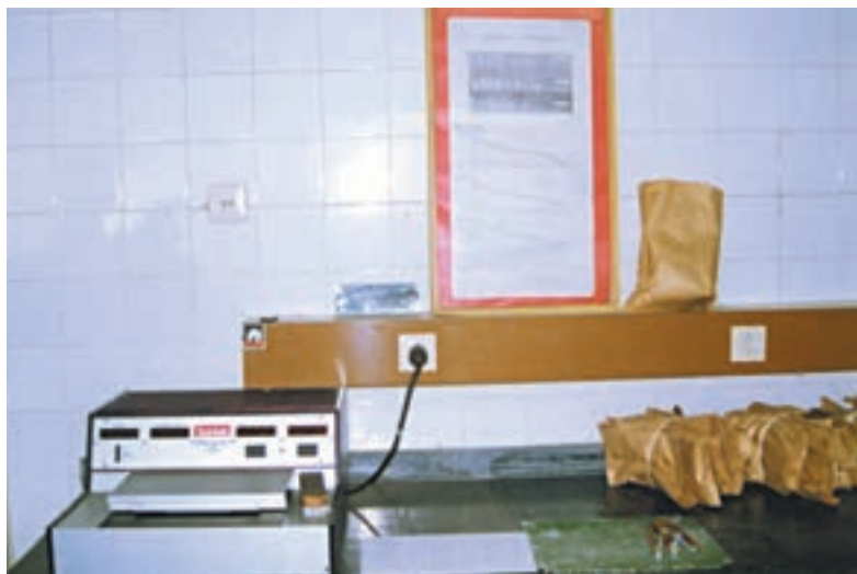
شکل ۱۹-۱ - دستگاه اندازه‌گیری طول و یکنواختی الیاف پنبه
