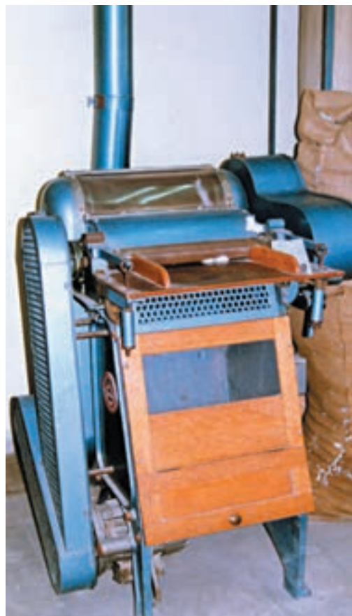
شکل ۱۸-۱-ب - دستگاه اندازه‌گیری خلوص الیاف پنبه
