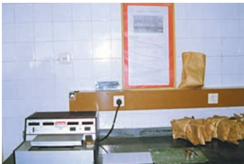
شکل ۱۹-۱ - دستگاه اندازه‌گیری طول و یکنواختی الیاف پنبه
