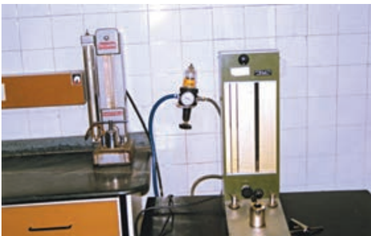
شکل ۱۸-۱ الف - دستگاه اندازه‌گیری ظرافت الیاف پنبه
