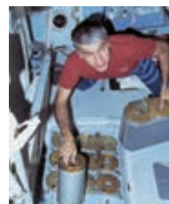
یک فضاانورد در حال تعویض قوطی های تصفیه هوای فضا پیماست.
