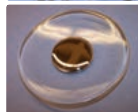
شکل ۳-۱۱ (الف) بخش آب روی سطح شیشه (ب) قطره‌ای شدن جیوه روی سطح شیشه
