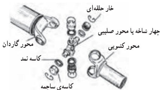
شکل ۲۹۱- اجزای قفل گاردان
