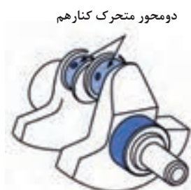
دو شاتون روی یک محور
