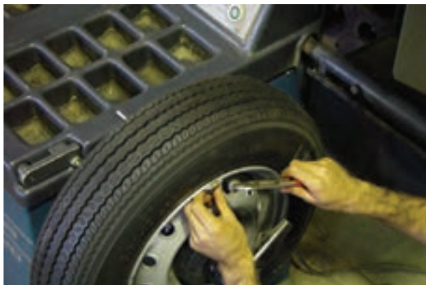
شکل ۲۳۸-۳- نصب وزنه روی قسمت بیرونی رینگ
