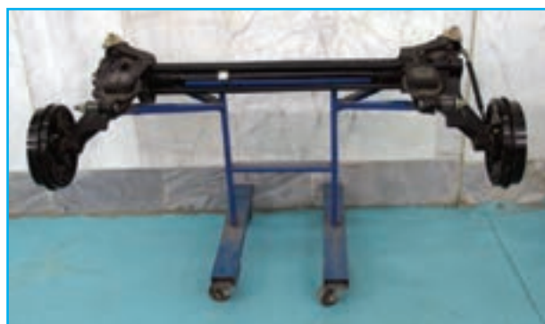
شکل ۱۵۹-۳- مجموعه تعلیق عقب
