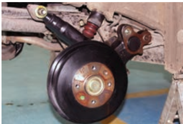
شکل ۱۷۷-۳- نصب کمک فنر
