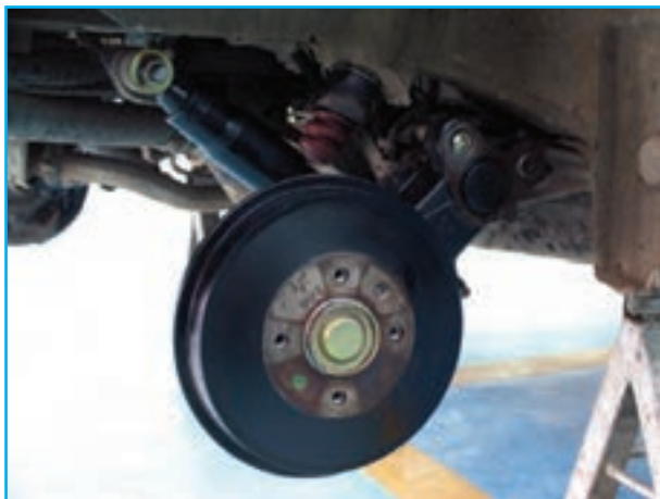
شکل ۱۸۳-۳- نصب ژامبون و متعلقات چرخ عقب
