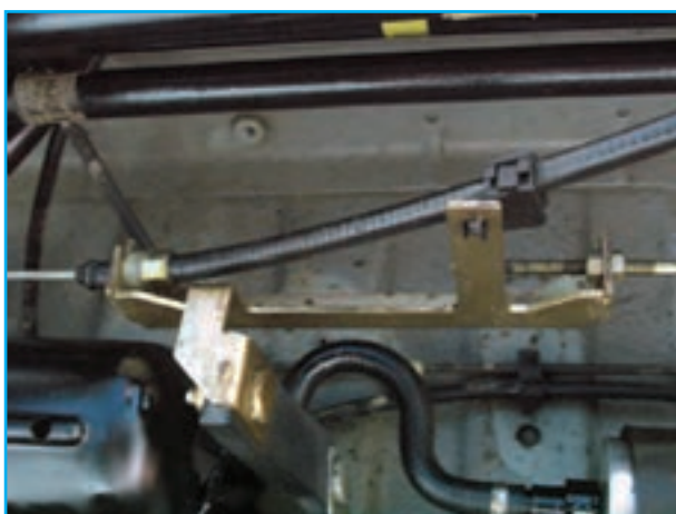
ب - باز کردن اجزای ترمز دستی در زیر خودرو
