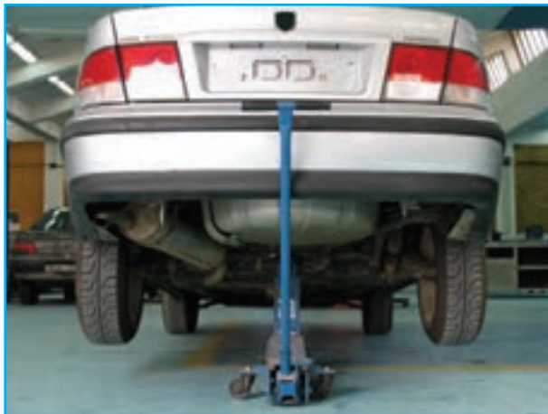
شکل ۳-۱۵۶- تنظیم ارتفاع و کنترل رام لوله‌ای
