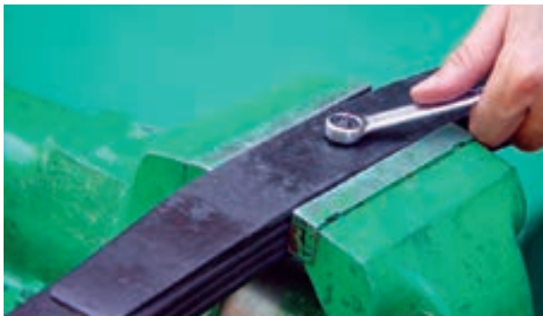
شکل ۳-۶۸- باز کردن پیچ مرکز فنرهای شمش
