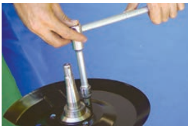
شکل ۳-۹۶- باز کردن صفحه پشت توپی چرخ
