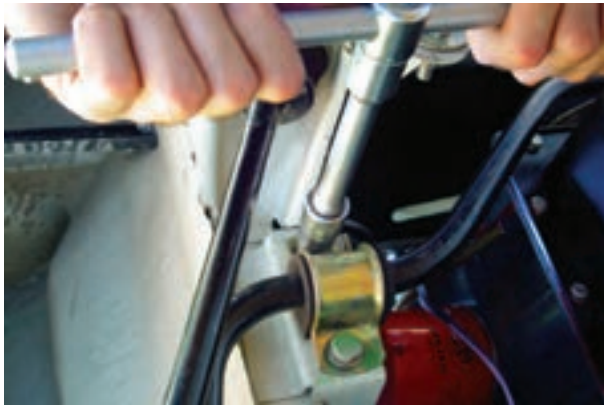
شکل ۳-۸۶- باز کردن میله ضد غلتش (موج گیر)
