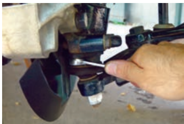
شکل ۳-۷۸- باز کردن سیبک زیر کمک فنر
