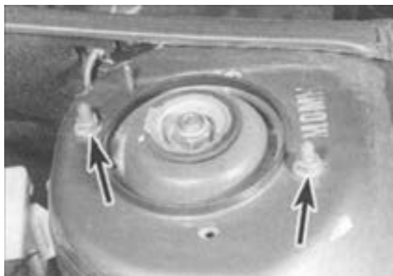
شکل ۱۱۹-۳- بستن پیچ‌های اتصال مجموعه به اتاق
