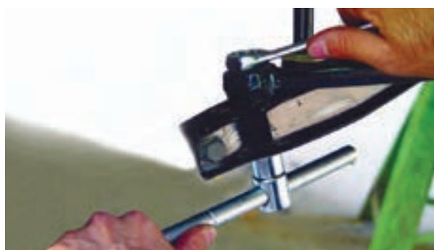
شکل ۳-۸۱ باز کردن میل تعادل از طبق
