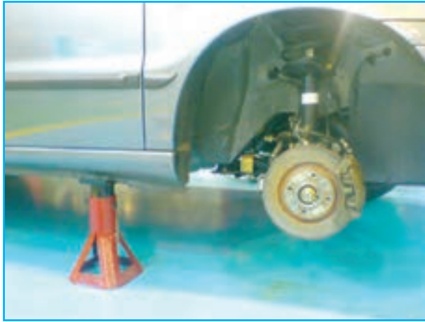
شکل ۳-۶۱- خودروی مستقر بر پایه قابل تنظیم
