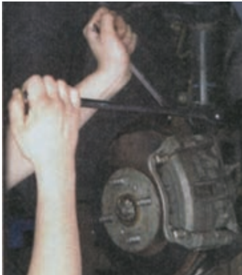
شکل ۳-۱۰۰ نصب مجموعه سیستم تعلیق روی خودرو
