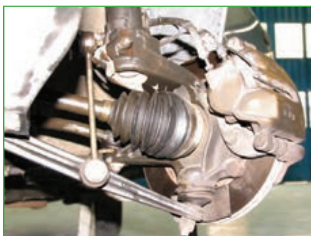
شکل ۳-۱۲۸- باز کردن پیچ‌های میل موج‌گیر
