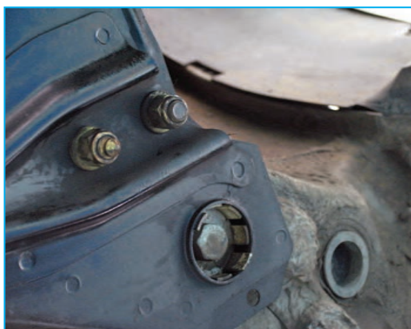
شکل ۳-۱۲۲- باز کردن پیچ های طبق
