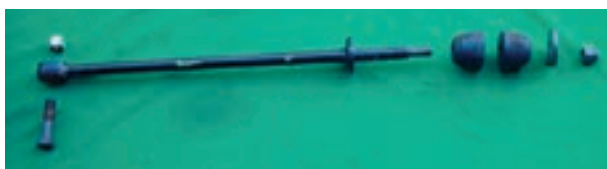
شکل ۳-۸۴- اجزای میل تعادل
