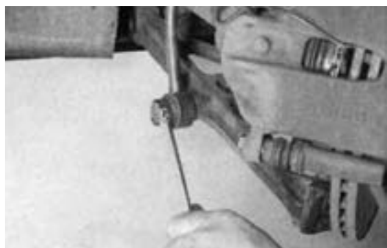
شکل ۱۲۰-۳- باز کردن میل موج‌گیر کوتاه به طبق
