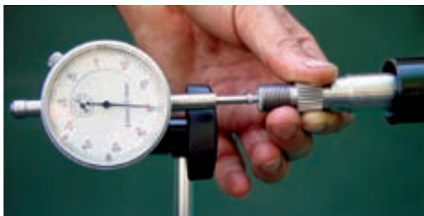
شکل ۶۸-۲- اندازه‌گیری لقی طولی میل فرمان
