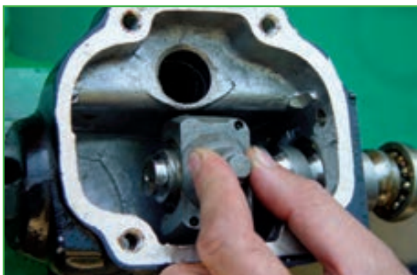
شکل ۲-۶۳- خارج کردن محفظه ساچمه‌ها
