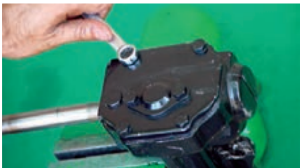
شکل ۲-۶۲- باز کردن درپوش بالایی جعبه فرمان
