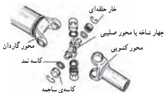
شکل ۲۹۱- اجزای قفل گاردان
