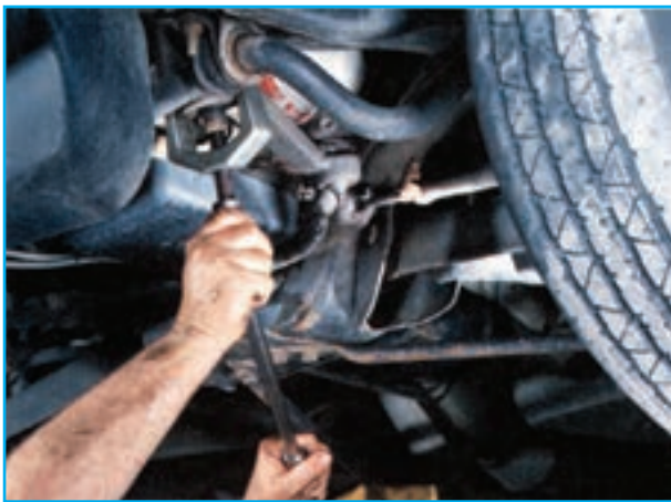
شکل ۴۷-۲- نحوه استفاده از نوعی سیبک کش
