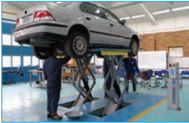
شکل ۴۶-۲- استقرار خودروی روی بالابر
