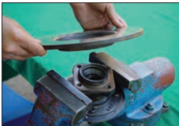
شکل ۱-۱۲۶- بازکردن دیسک ترمز
