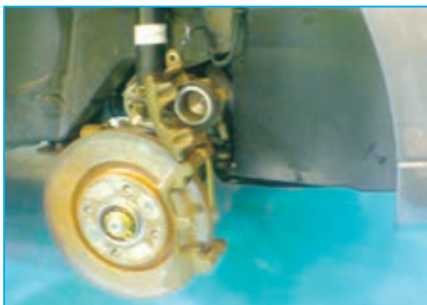
شکل ۱۱۰-۱- باز کردن پوسته نگاه‌دارنده لنت‌ها
