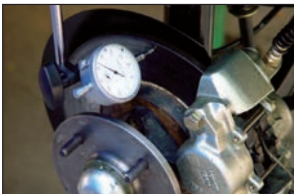
شکل ۱-۱۲۳- بررسی وضعیت دیسک
