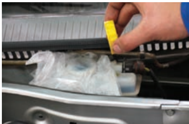
شکل ۱۳۸-۱- مسدود کردن در مخزن مایع ترمز
