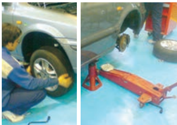
شکل ۱-۱۱۷- بالا بردن و پیاده کردن چرخ جلو
