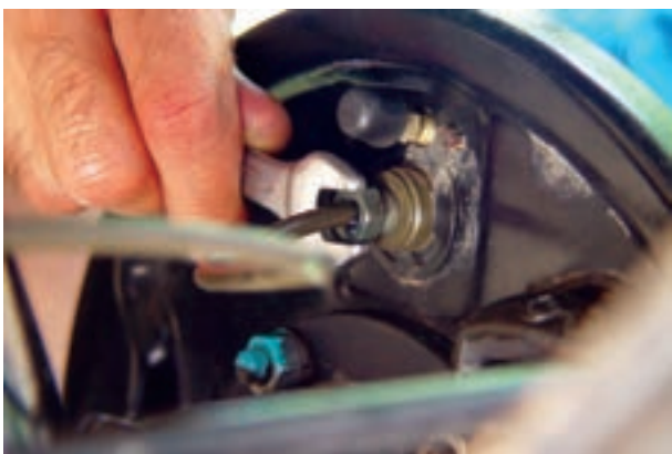
شکل ۱۰۵-۱- باز کردن مهره اتصال لوله ترمز
