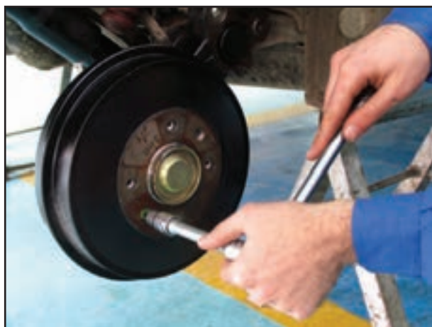
شکل ۱-۱۰۲- بستن پیچ نگه‌دارنده کاسه چرخ
