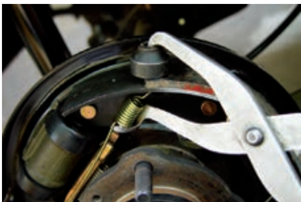
شکل ۱-۱۰۷- جازدن فنر بالایی کفشک
