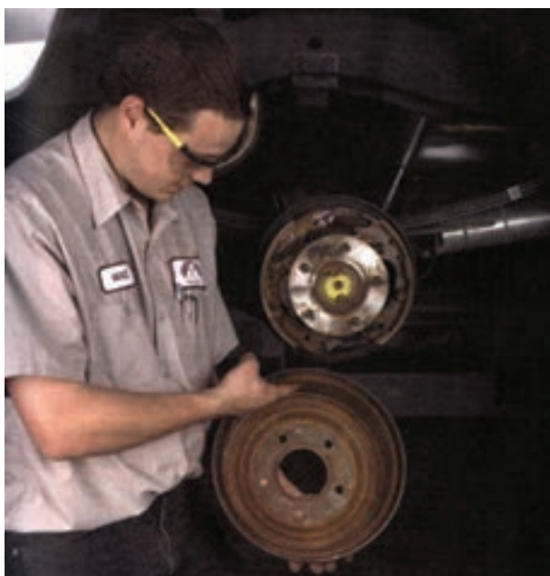
شکل ۹۶-۱- کنترل کاسه چرخ
