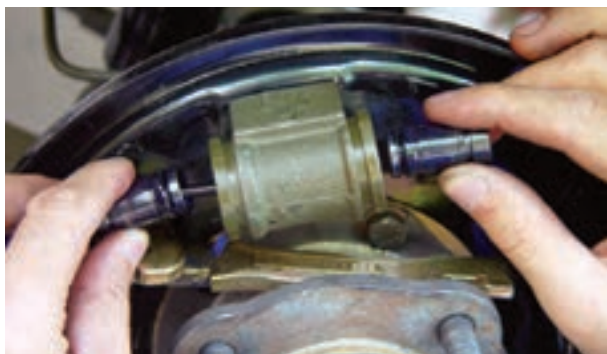
شکل ۹۴-۱- خارج کردن پیستون‌ها
