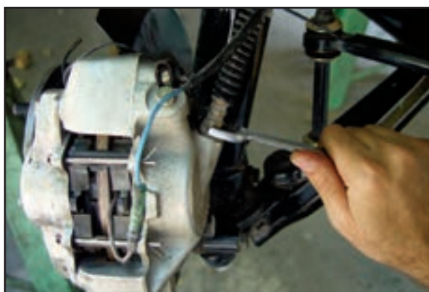
شکل ۱۱۹-۱ باز کردن شیلنگ ترمز
