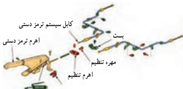
شکل ۱-۴۶-ا- اجزای سیستم ترمز دستی
