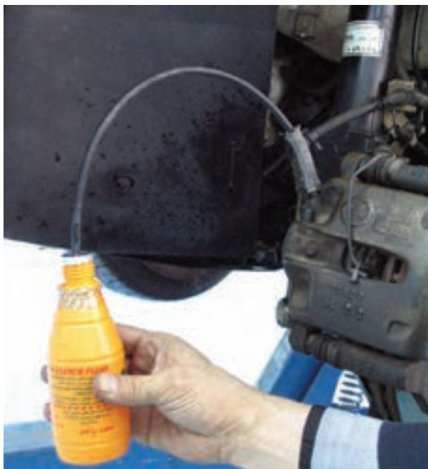
شکل ۱-۷۱- نصب لوله پلاستیکی روی پیچ هواگیری
