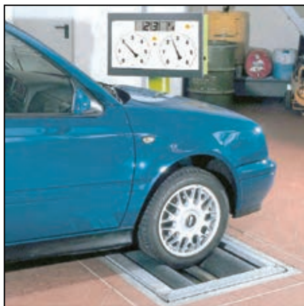
شکل ۱-۷۴- دستگاه آزمایش دینامیکی ترمز
