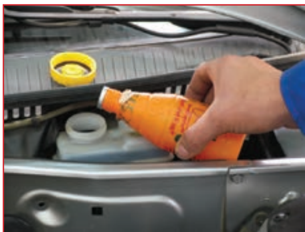
شکل ۱-۶۸- برکردن مخزن مایع ترمز تا حداکثر (MAX)
