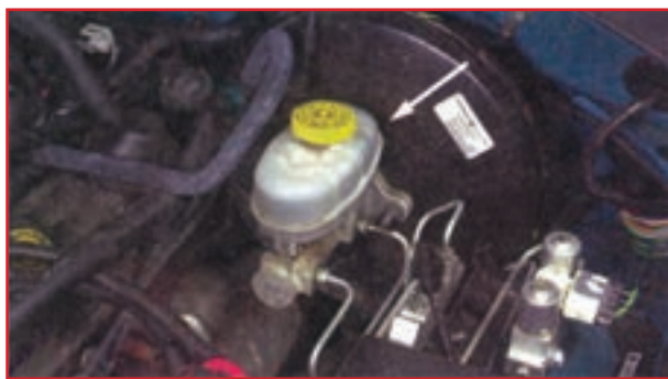
شکل ۱-۷۸- مخزن مایع ترمز و پمپ اصلی
